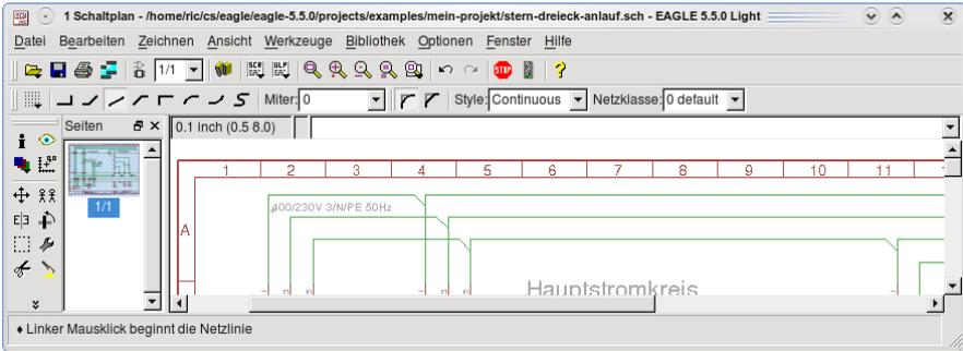
Bitte achten Sie darauf, dass Netzlinien exakt am Anfang des Kontakts (Pins) beginnen oder enden, sonst ist das Netz nicht angeschlossen (siehe auch ERC-Befehl; er enthält eine Prüfung auf scheinbar angeschlossene Pins).
