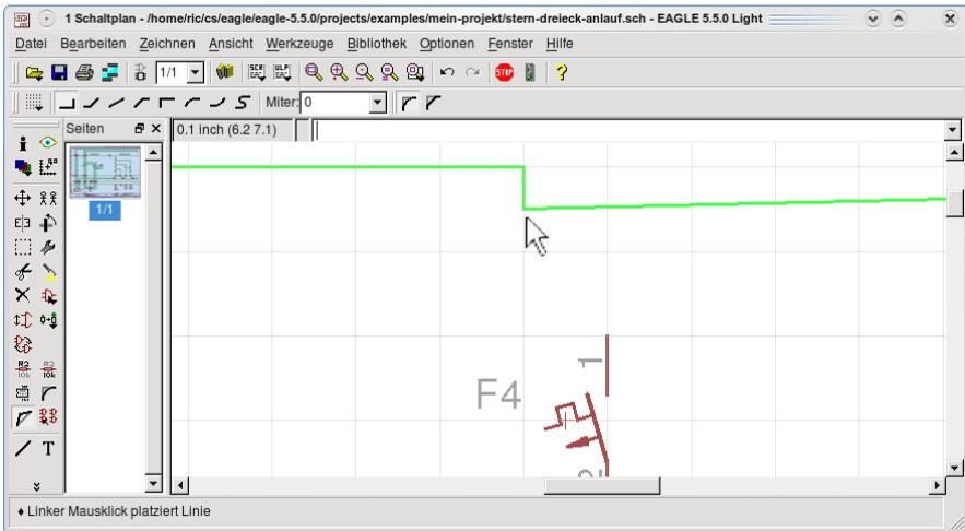
Ziehen Sie den Cursor im 45-Grad-Winkel ein halbes Raster nach oben und schließen Sie den Vorgang mit •• ab.
