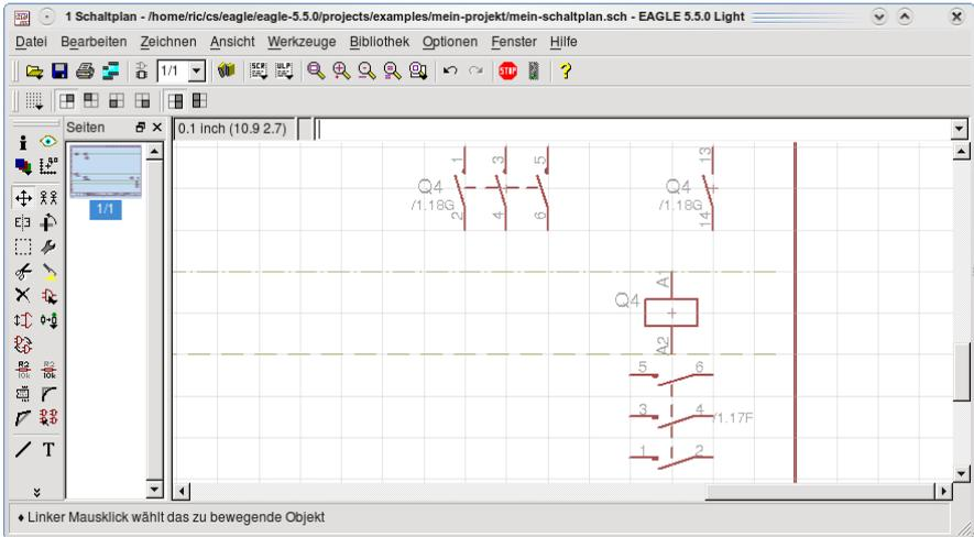
Platzieren Sie das Schütz entsprechend der Vorlage im Schaltplan.
