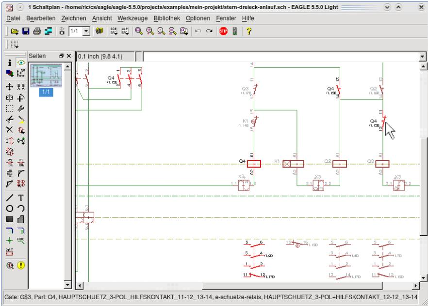
Wird dagegen ein Bauteil mit MOVE so abgesetzt, dass ein Pin auf einem Netz liegt, dann wird dieser Pin auf jeden Fall angeschlossen. Eine scheinbare Verbindung lässt sich also damit beheben, dass man mit aktiviertem MOVE-Befehl das Bauteil anklickt und wieder absetzt.
