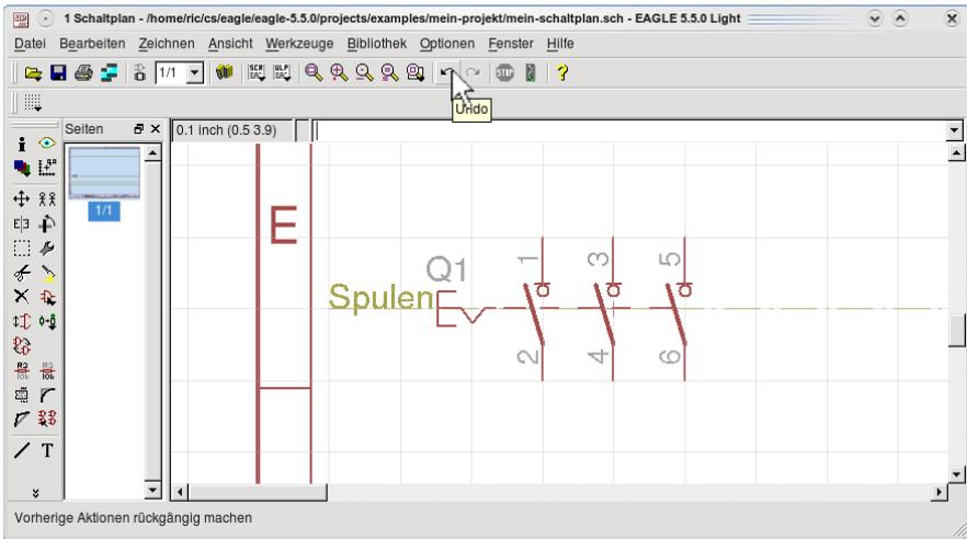
Platzieren Sie das Bauteil an einer beliebigen Stelle in der Zeichnung. Das weitere Bauteil entfernen Sie mit **•** auf STOP oder Drücken der Esc-Taste (2 Mal). Für später sollten Sie sich merken, dass auf diese Weise EAGLE-Befehle abgebrochen werden können (oder durch Aktivieren eines neuen Befehls).
