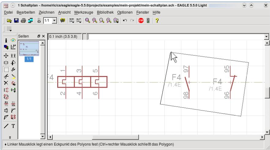
Aktivieren Sie jetzt MOVE und drücken Sie Strg + rechte Maustaste. Die Gruppenobjekte hängen dann am Cursor und können mit der linken Maustaste abgesetzt werden. Analog dazu löschen Sie ganze Bereiche, indem Sie erst eine Gruppe definieren und dann den DELETE-Befehl mit Strg + rechte Maustaste verwenden.
