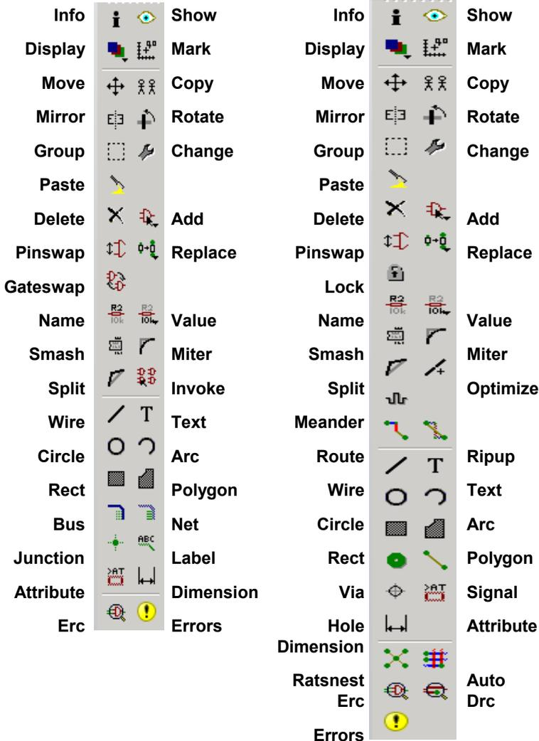
➤ 原理图编辑器（左）和PCB 编辑器（右）的命令工具栏
