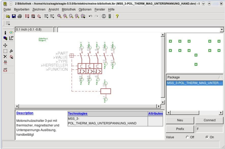
Das Symbol enthält die zeichnerische Darstellung für den Schaltplan (Schaltzeichen). Dazu gehören die Anschluss-Pins (Kontakte) und Platzhalter für den Namen und den Wert (Value). Zusätzlich können noch Platzhalter für Attribute definiert sein, die es ermöglichen, in der Schaltung weitere Eigenschaften (Stromstärke etc.) anzuzeigen.
