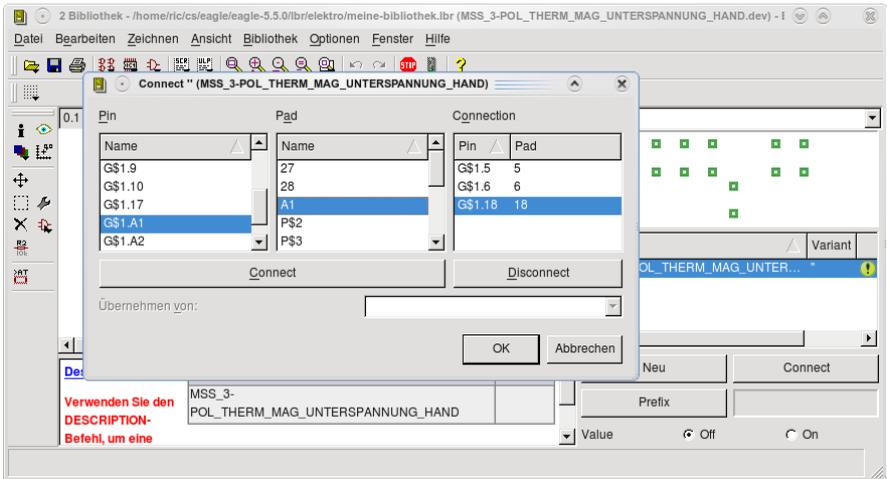
Sind alle Pins mit Pads verbunden, schließen Sie den Dialog mit • auf OK. Tragen Sie nun *F* für den Prefix (Kennbuchstabe des Bauteils) ein und bestätigen Sie mit OK.
