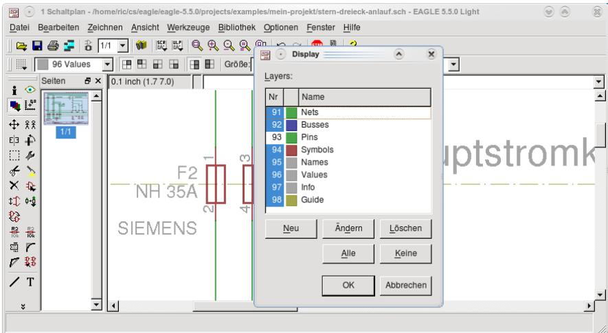
Wollen Sie alle Klemmpunkte in Ihrer Schaltung anzeigen, klicken Sie die 93 an und bestätigen Sie mit OK. In Ihrer Schaltung werden alle Klemmstellen angezeigt. Spielen Sie auch den umgekehrten Fall durch. Schalten Sie den eingeschalteten Layer 98 (Guide) aus und die Zeichnungshilfslinien werden ausgeblendet.
