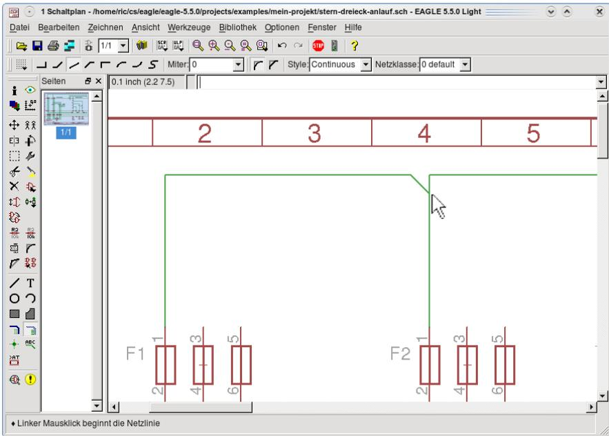
Im EAGLE-Schaltplan bedeutet diese Darstellung eines Abzweigs, dass ab der Pfeilspitze zwei Leitungen zum nächsten Klemmpunkt eines Bauteiles laufen. Halten Sie diese Darstellungsform nicht ein, wird der Klemmenplan eventuell nicht korrekt erstellt.
